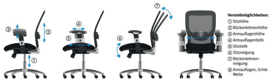
Abb. 12 Verstellmöglichkeiten an einem Büroarbeitsstuhl
